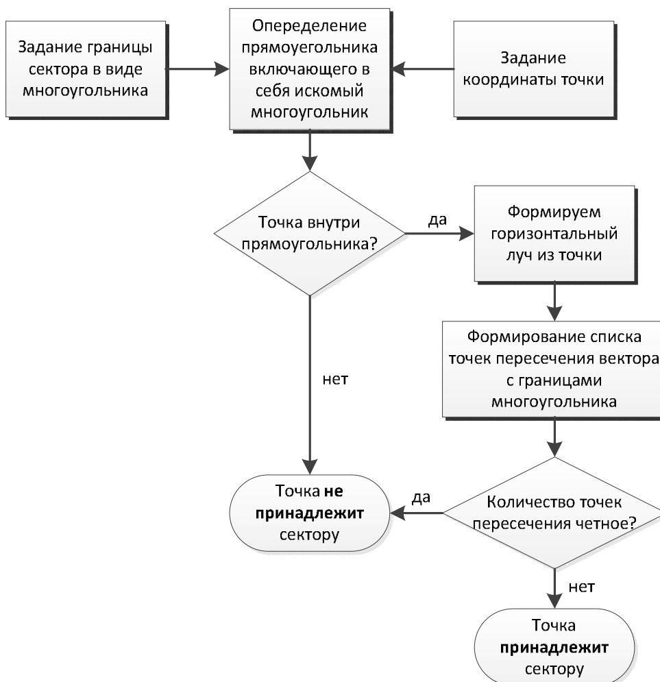
Рис. 7. Алгоритм определения принадлежности точки сектору
