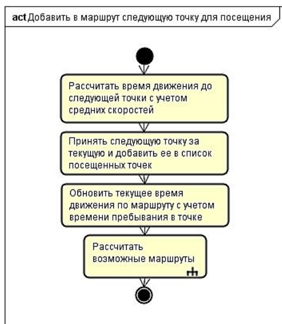
Рисунок 2 – Алгоритм расчета участка между двумя пунктами маршрута
