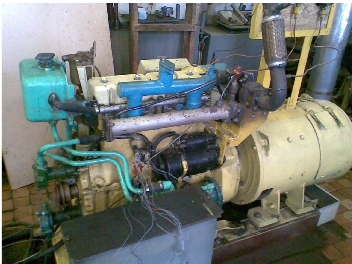
Рис. 1. Общий вид экспериментальной установки для исследования дизеля 4ЧН9,5/11
