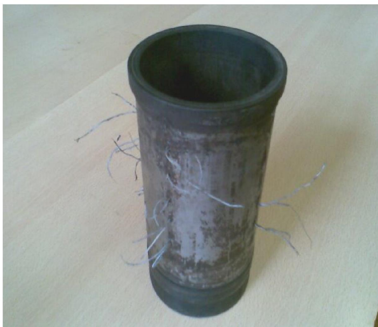
Рис. 2. Цилиндровая втулка, препарированная термопарами
