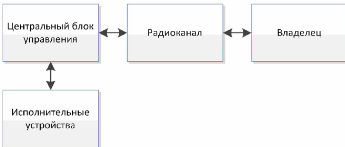
Рис. 1. Схема РОСА с использованием радиоканала
