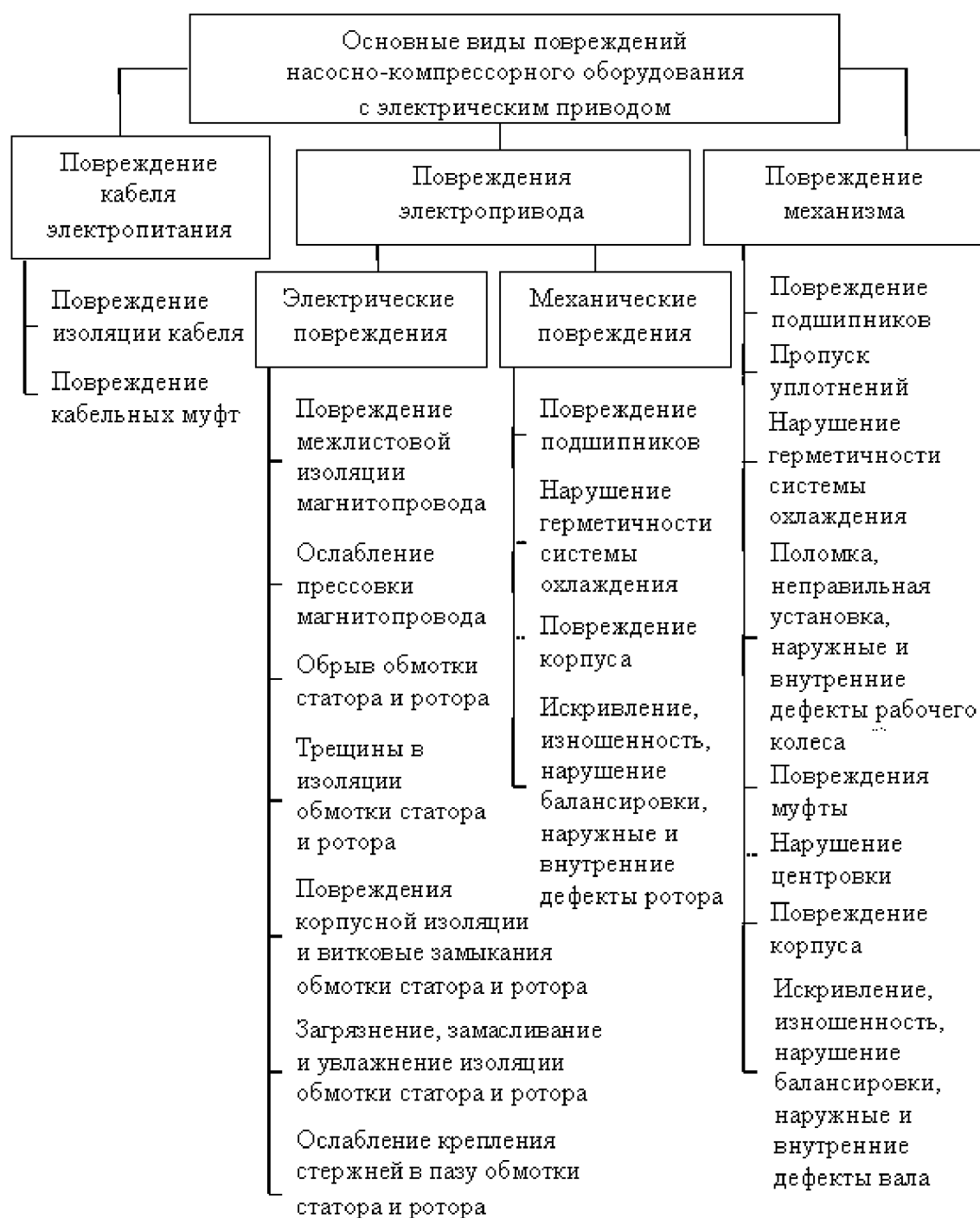
Рис. 2. Основные виды повреждений насосно-компрессорного оборудования с электрическим приводом
