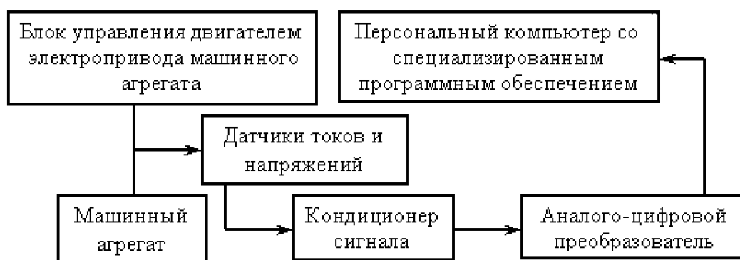
Рис. 3. Структурная схема программно-аппаратного комплекса для реализации спектрального метода диагностики насосно-компрессорного оборудования с электрическим приводом
