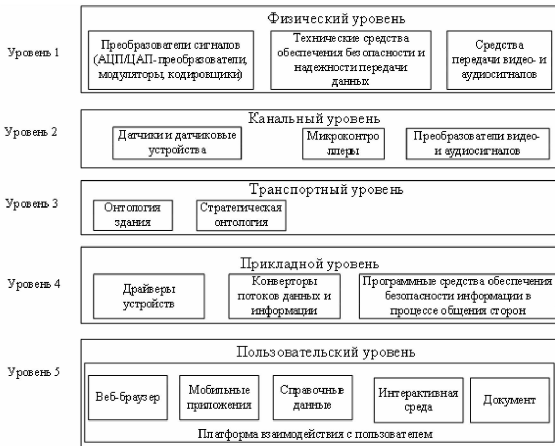
Рис. 2. Иерархическая структура передачи данных в ИСУЗ
