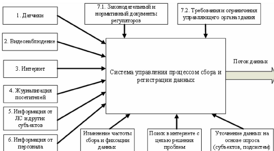
Рис. 1. Источники входных данных систем управления зданием
