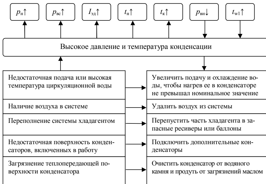
Рис. 2. Диаграмма взаимосвязей для признака неисправности «высокое давление и температура конденсации»: p_n – давление нагнетания компрессора, МПа; p_{vc} – давление всасывания компрессора, МПа; I_{эд} – сила тока в электродвигателе компрессора, А; t_n – температура нагнетания компрессора, °С; t_k – температура конденсации, °С; p_{вн} – давление водяного насоса, МПа; t_{w1} – температура воды, поступающей на конденсатор, °С; стрелки рядом с обозначением параметра показывают, увеличение или уменьшение данного параметра влияет на данную неисправность или зависит от нее
