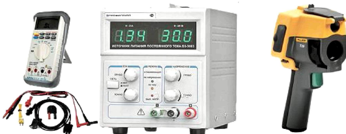
Рис. 4. Приборы, использованные для проведения экспериментальных исследований: термопара, мультиметр, источник питания, тепловизор
