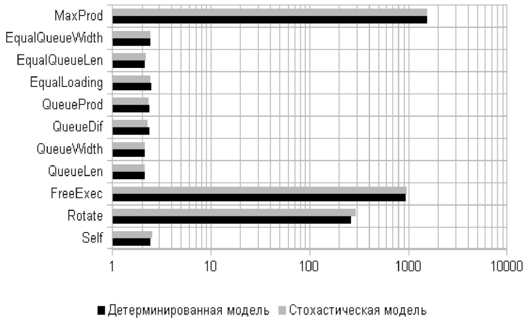
Рис. 6. Среднее время ожидания результата расчета при моделировании Грид-системы
