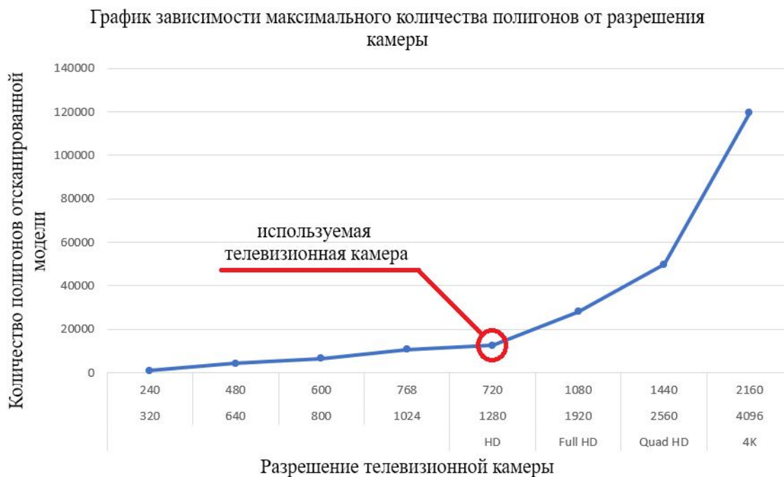
Рисунок 4 – Диаграмма зависимости максимально возможного количества полигонов модели от разрешения телекамеры
