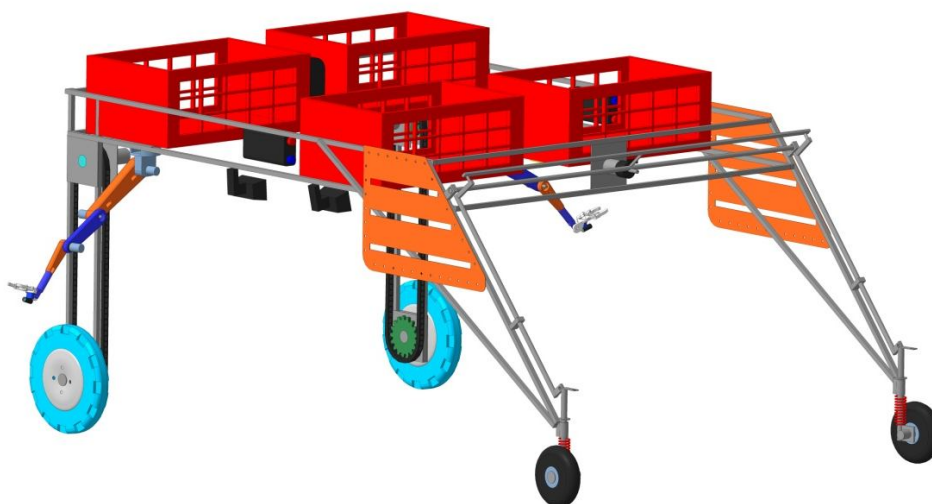
Рисунок 13 – 3D-модель робота для сбора урожая
