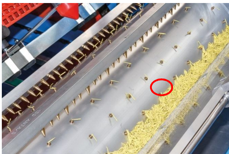
Рисунок 4 – Способ прикрепления семян сложной формы на барабан [7]
