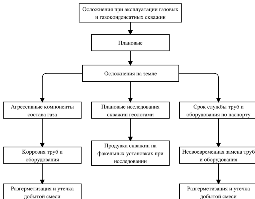
Рисунок 2б – Основные плановые осложнения на земле при эксплуатации скважины
