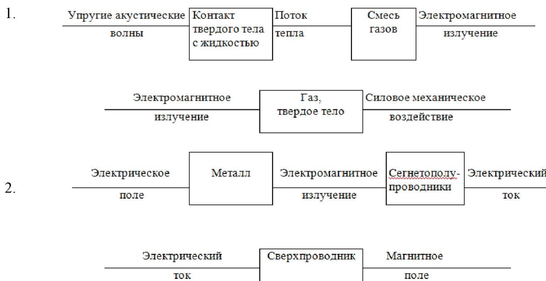
Рис. 3. Физические принципы действия двух датчиков
