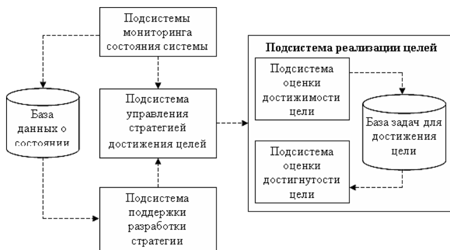
Рис. 5. Архитектура программного комплекса поддержки управляемого поведения СЭС
