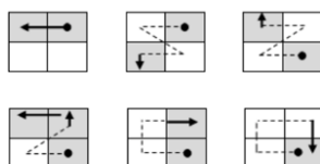
Траектории поиска пикселей предложенным алгоритмом, способным отследить пиксели на прямой, пиксели внутренне-внешнего, внутреннего и внешнего угла Pixel search trajectories by the proposed algorithm, capable of tracking pixels on a straight line, pixels of the inner-outer, inner and outer corner
