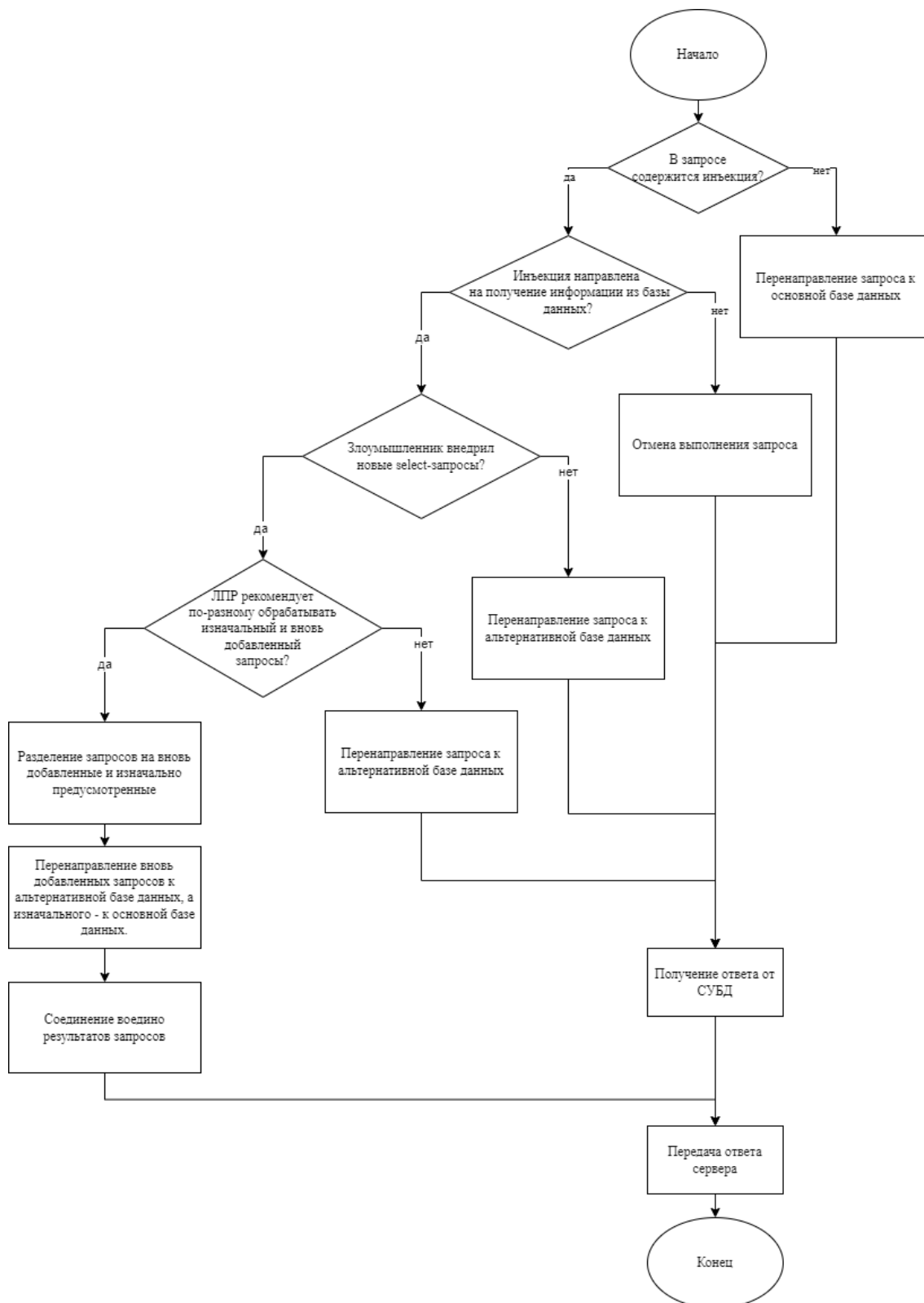
Рисунок 4 – Блок-схема алгоритма анализа пользовательских запросов к СУБД
