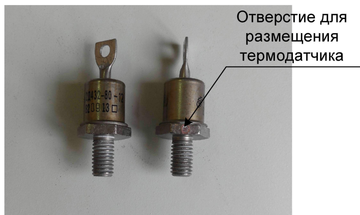
Рис. 1. Внешний вид силового диода 2Д432-80 с отверстием для размещения термодатчика
