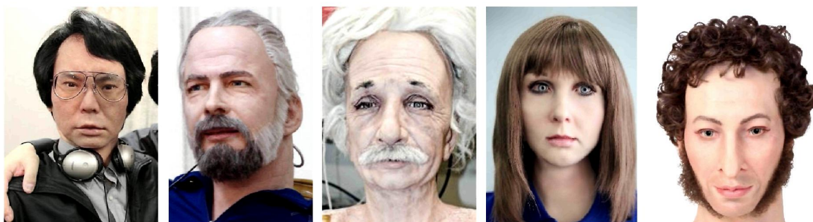
а б в г д Рис. 7. СР с антропоморфным силиконовым «лицом»: а – производства Hiroshi Ishiguro Laboratories; б – «Филипп Дик»; в – «Альберт Эйнштейн», (оба производства Hanson Robotics); г – «Алиса Зеленоградова»; д – «Пушкин» (оба производства Нейроботикс, Россия)
