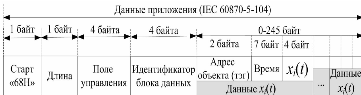
Рис. 4. Структура блока данных прикладного уровня (IEC 60870-5-104)
