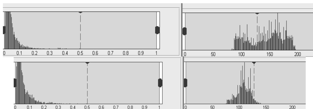
Рисунок 4 – Гистограммы распределения яркости оконных фрагментов рентгенограммы грудной клетки (справа) и гистограммы их оконных двумерных амплитудных преобразований Фурье (слева)
